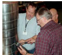
El instructor muestra a los estudiantes cómo probar la calidad del aire dentro de un espacio confinado.
